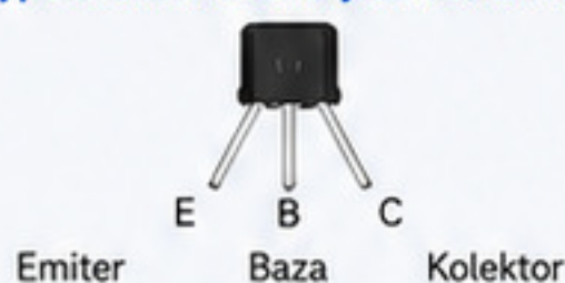
Wyprowadzenia tranzystora (2N2222):
