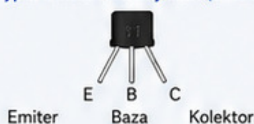
Wyprowadzenia tranzystora (2N2222)
