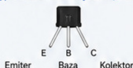
Wyprowadzenia tranzystora (2N2222)
